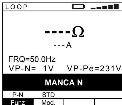
Connessione del conduttore di neutro assente
