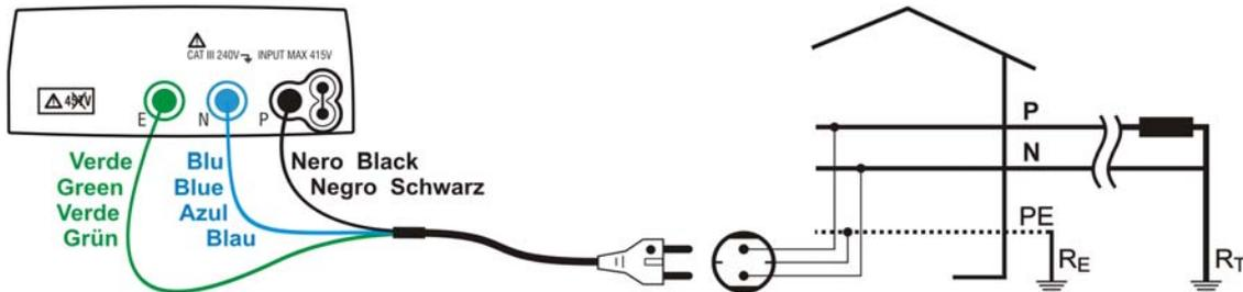
Fig. 18: Misurazione della resistenza globale di terra in impianti monofase o bifase 230V tramite spina shuko
