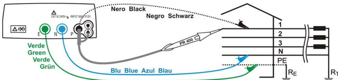
Fig. 20: Misurazione della resistenza globale di terra in impianti trifase 400V + N + PE tramite cavi singoli e puntale remoto
