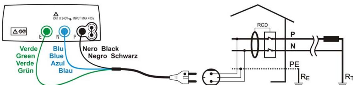
Fig. 8: Verifica dell'interruttore differenziale monofase o bifase 230V tramite spina shuko
