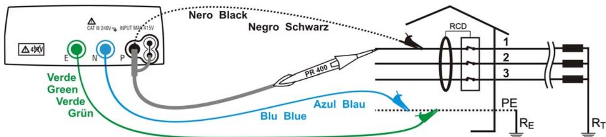
Fig. 12: Verifica dell'interruttore differenziale trifase 400V + PE (senza N) tramite cavi singoli e puntale remoto
