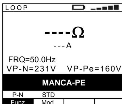
Conduttore di protezione e/o impianto di terra non efficienti
