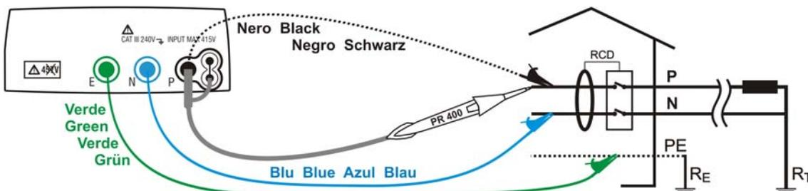
Fig. 9: Verifica dell'interruttore differenziale monofase o bifase 230V tramite cavi singoli e puntale remoto
