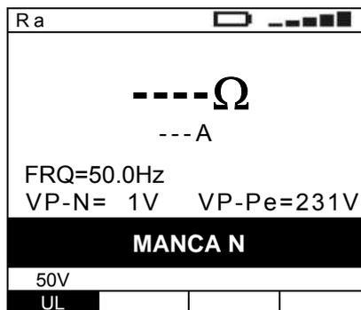
Connessione del conduttore di neutro assente
