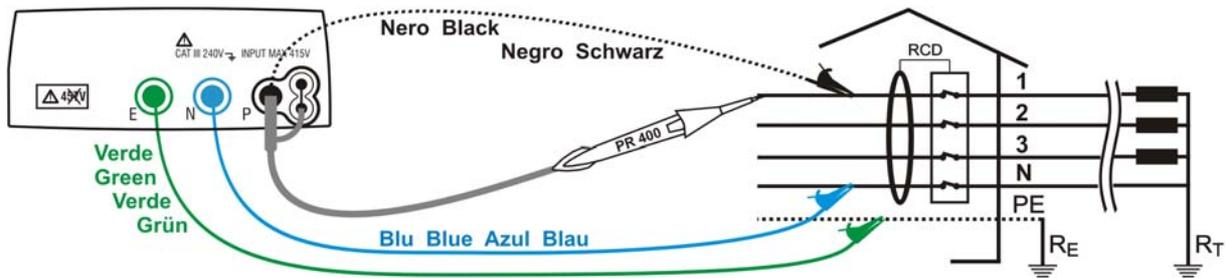
Fig. 10: Verifica dell'interruttore differenziale trifase 400V + N + PE tramite cavi singoli e puntale remoto
