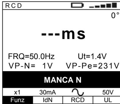
Connessione del conduttore di neutro assente
