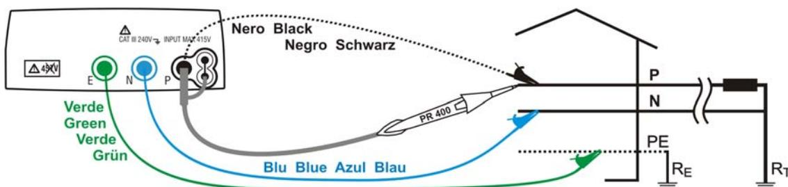
Fig. 14: Misurazione dell'impedenza di linea fase – neutro o dell'impedenza dell'anello di guasto in impianti monofase o bifase 230V tramite cavi singoli e puntale remoto
