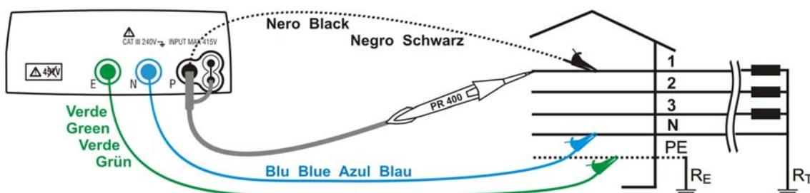
Fig. 15: Misurazione dell'impedenza di linea fase – neutro o dell'impedenza dell'anello di guasto in impianti trifase 400V + N + PE tramite cavi singoli e puntale remoto
