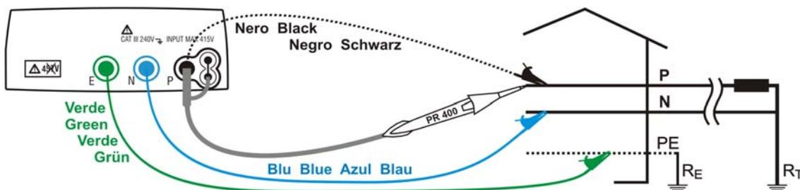
Fig. 19: Misurazione della resistenza globale di terra in impianti monofase o bifase 230V tramite cavi singoli e puntale remoto
