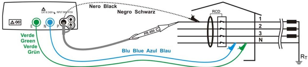
Fig. 11: Verifica dell'interruttore differenziale trifase 400V + N (senza PE) tramite cavi singoli e puntale remoto
