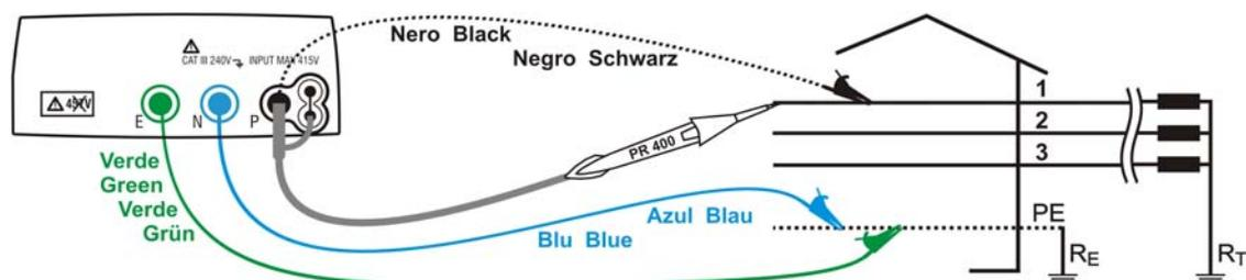
Fig. 21: Misurazione della resistenza globale di terra in impianti trifase 400V + PE (senza N) tramite cavi singoli e puntale remoto
