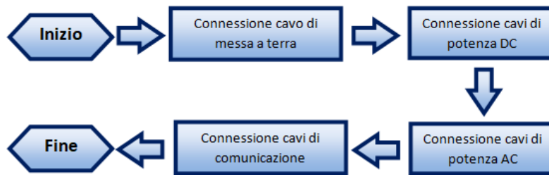
Figura 17 - Passaggi per la connessione dei cavi
