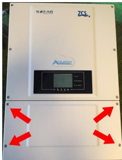
Figura 39 - Estrazione del coperchio centrale
