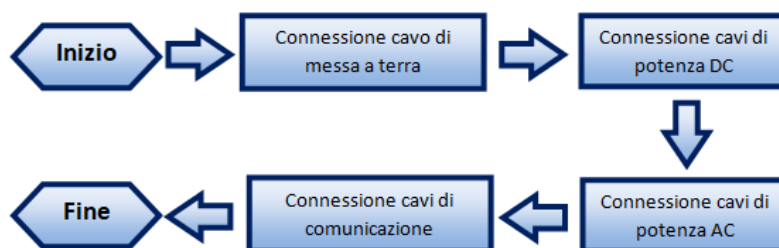
Figura 16 – Passaggi per la connessione dei cavi
