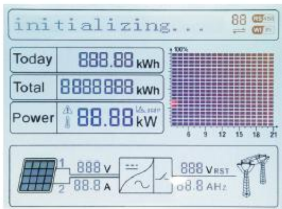
Figura 42 - Interfaccia principale del display LCD
