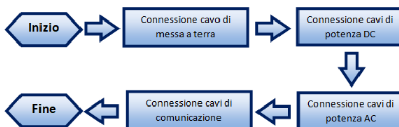
Figura 13 - Passaggi per la connessione dei cavi
