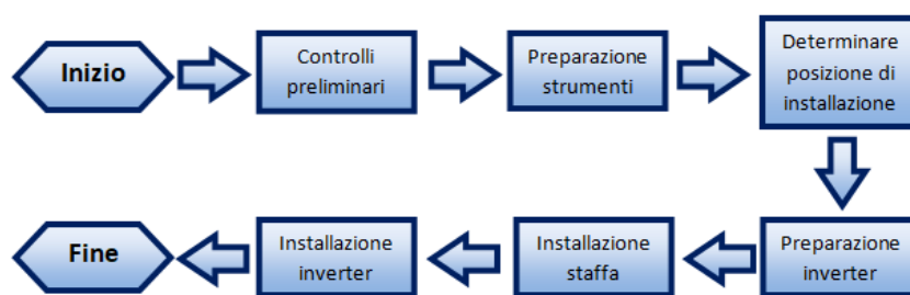
Figura 7 - Passaggi di installazione
