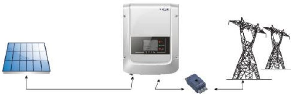
Figura 2 - Impianto fotovoltaico connesso in rete
