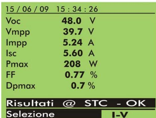
**I-V 400** dispone di ampio display grafico in grado di visualizzare simultaneamente tutte le informazioni necessarie alla valutazione delle CT dei pannelli compreso l'esito OK/NO del confronto con i dati forniti dal costruttore dei pannelli
