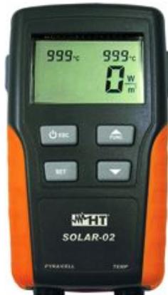
L'unità remota SOLAR-02 consente la visualizzazione delle misure di irraggiamento e temperatura anche in modo indipendente (ideale in fase di pre-collaudo) e registrazione in fase di collaudo con unità master SOLAR300N
