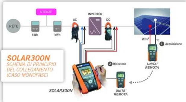
**SOLAR300N** esegue il collaudo su impianti FV con uso di unità remota SOLAR-02 che, dopo una fase di sincronizzazione, registra in modo indipendente i valori di irraggiamento e temperatura per essere poi ricollegata all'unità master al termine del collaudo
