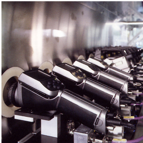
Figura 17.4 SINISTRA: Collaudo delle termocamere a infrarossi nella camera climatica; DESTRA: Robot per il collaudo e la calibrazione delle termocamere
