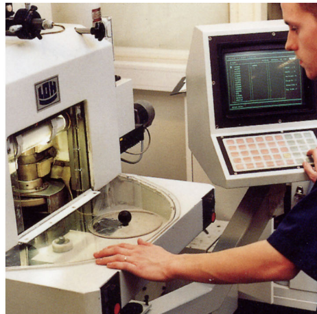
Figura 17.3 SINISTRA: tornio a punta di diamante; DESTRA: lucidatura dell'obiettivo
