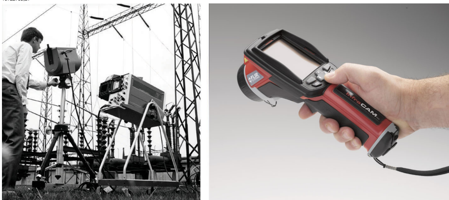
Figura 17.1 SINISTRA: Thermovision® Modello 661 del 1969. La termocamera pesava circa 25 kg, l'oscilloscopio 20 kg e il treppiedi 15 kg. L'operatore inoltre doveva procurarsi un gruppo elettrogeno da 220 VCA e un contenitore da 10 litri con azoto liquido. Alla sinistra dell'oscilloscopio è visibile l'attacco Polaroid (6 kg). DESTRA: InfraCAM del 2006. Peso: 0,55 kg, batteria inclusa
