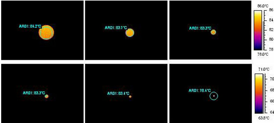
Figura 16.20 Letture della temperatura di un corpo nero a +85°C a distanze sempre maggiori (obiettivo a 24°)
