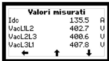
E' possibile navigare attraverso i valori con i tasti freccia ↓ e ↑. Premendo il tasto di sinistra ← si torna al Menu principale.
