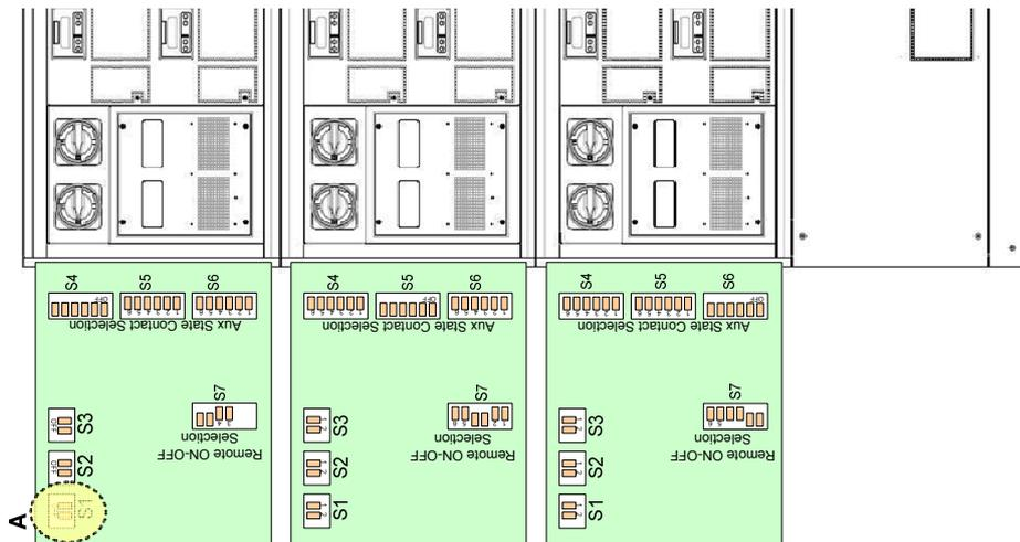
Figura 11-9: Posizione dip-switch terminazione 120 ohm
