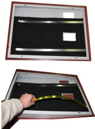
Figura 16-2: Rimozione del filtro “Zona Moduli 55kWp”
