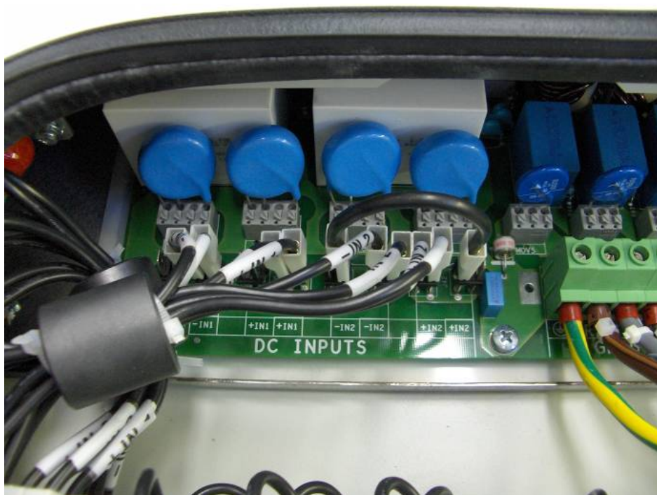
Fig.13 Collegamenti necessari per eseguire il corto-circuito sul canale 2
