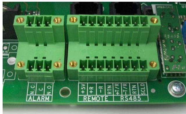
Fig. 24: morsettiera dei contatti di allarme
