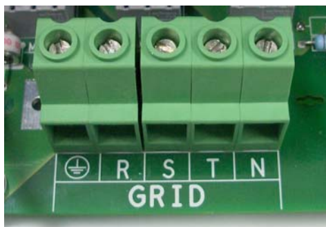
Fig.11 Morsettiera per connessione cavi AC
