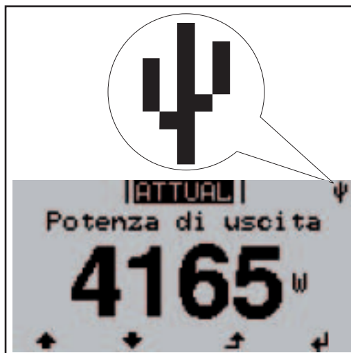
Icona USB sul display dell'inverter, ad es. nella modalità di visualizzazione „ATTUAL“
