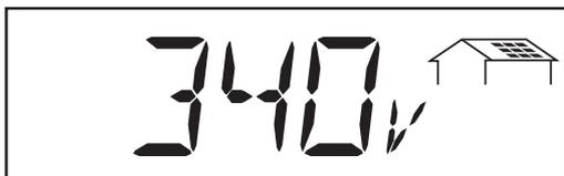
**Tensione modulo**... tensione istantanea nei moduli solari (volt)
