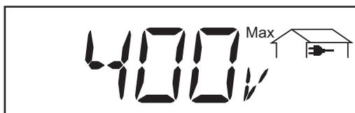
**Tensione di rete massima** ... la massima tensione di rete (V) misurata durante il periodo considerato .. dalla fase della fonte d'energia master ... il valore misurato vale per la rete a corrente trifase
