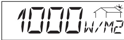
\* **Irraggiamento solare** ... potenza di irraggiamento incidente su ogni metro quadrato (Watt/m<sup>2</sup>; opzione scheda sensore)
