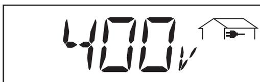
**Tensione di rete** (volt) ... dalla fase della fonte d'energia master... il valore misurato vale per la rete a corrente trifase
