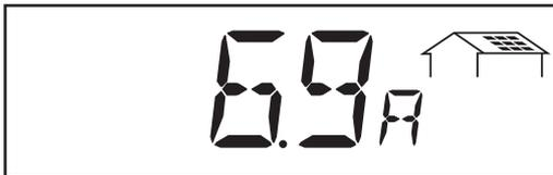
**Corrente modulo** ... corrente istantanea fornita dai moduli solari ... (ampere)
