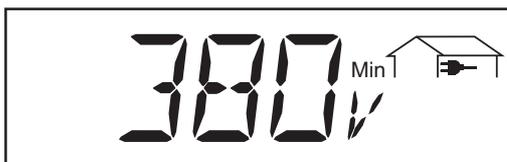
**Tensione di rete minima** ... la minima tensione di rete (V) misurata durante il periodo considerato .. dalla fase della fonte d'energia master ... il valore misurato vale per la rete a corrente trifase
