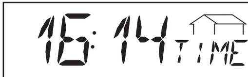
\* **Ora** (opzione Datalogger) ... se si modifica l'ora in un FRONIUS IG o in una estensione del sistema, questa viene modificata in tutti gli apparecchi collegati tramite la LocalNet.
