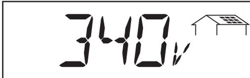
**Tensione modulo** ... tensione del modulo solare presente al momento della rilevazione (Volt)
