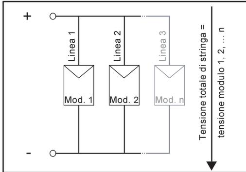
Collegando parallelamente diverse stringhe si aumenta al massimo la potenza e la corrente, mentre la tensione rimane la stessa. L'insieme di tutti questi moduli collegati parallelamente e in serie viene definito generatore solare.
