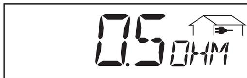
\* **Impedenza di rete ...** Resistenza della rete - criterio per un'alimentazione di rete sicura (Ohm; opzione ENS)
