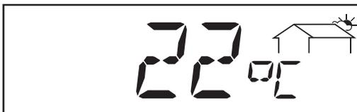
\* **Temperatura ambientale** (°C; °C; regolabile anche in °F nel menù di settaggio; sensore di temperatura Nr.2; opzione scheda sensore)
