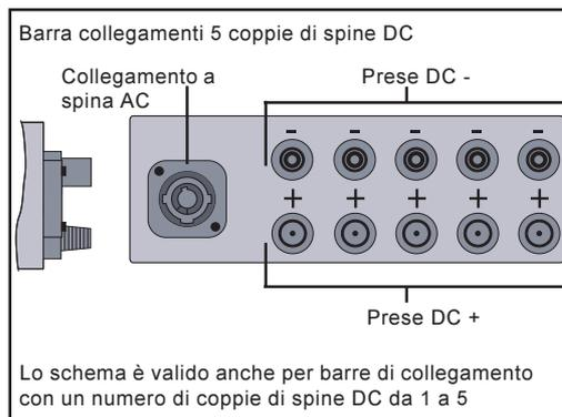
**Avvertenza!** Durante il montaggio dei collegamenti a spina DC accertarsi, per l'attacco dei moduli solari, che la polarità dei moduli solari coincida con i simboli „+“ e „-“.
