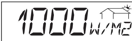
\* **Irradiazione solare** ... potenza d'irradiazione per metro quadrato (Watt/m<sup>2</sup>; opzione scheda sensore)
