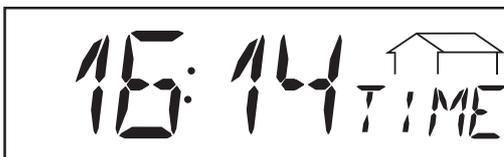
\* **Ora esatta** (opzione datalogger) ... modificando l'ora in un FRONIUS IG o nell'estensione di un sistema la variazione verrà effettuata in tutti gli apparecchi collegati mediante LocalNet.
