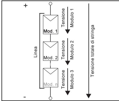
La potenza in uscita e la tensione aumentano mediante l'utilizzo combinato di diversi moduli solari. Mettendo insieme i moduli solari in serie si aumenta sia la potenza sia la tensione.
