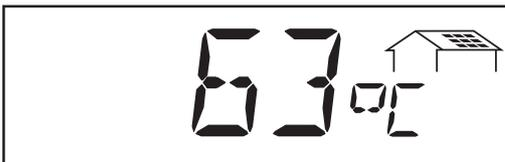
\* **Temperatura modulo** ... temperatura regolabile nei moduli solari (°C; anche regolabile in °F nel menù di settaggio; sensore temperatura Nr. 1; opzione scheda sensore)
