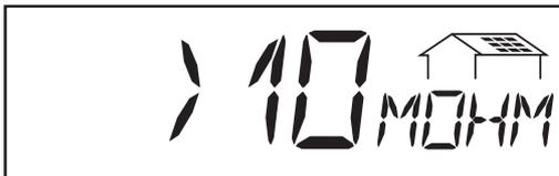
**Resistenza all'isolamento** dell'impianto fotovoltaico (MOhm)
