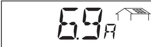
**Corrente modulo** ... corrente fornita dai moduli solari in quel momento (Ampere)
