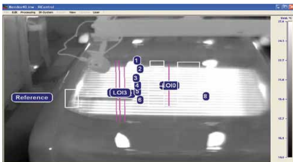
Lo speciale strumento software fornito da Rato a Ford Genk confronta le misurazioni della temperatura prese dalla termocamera FLIR A320 lungo le linee viola.
