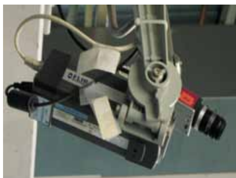
Questa termocamera FLIR A320 è utilizzata per controllare se il sistema di riscaldamento del vetro posteriore ha delle resistenze difettose.
