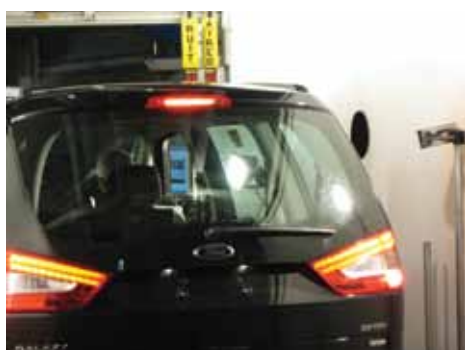
Il collaudatore accende le resistenze posteriori al massimo.
