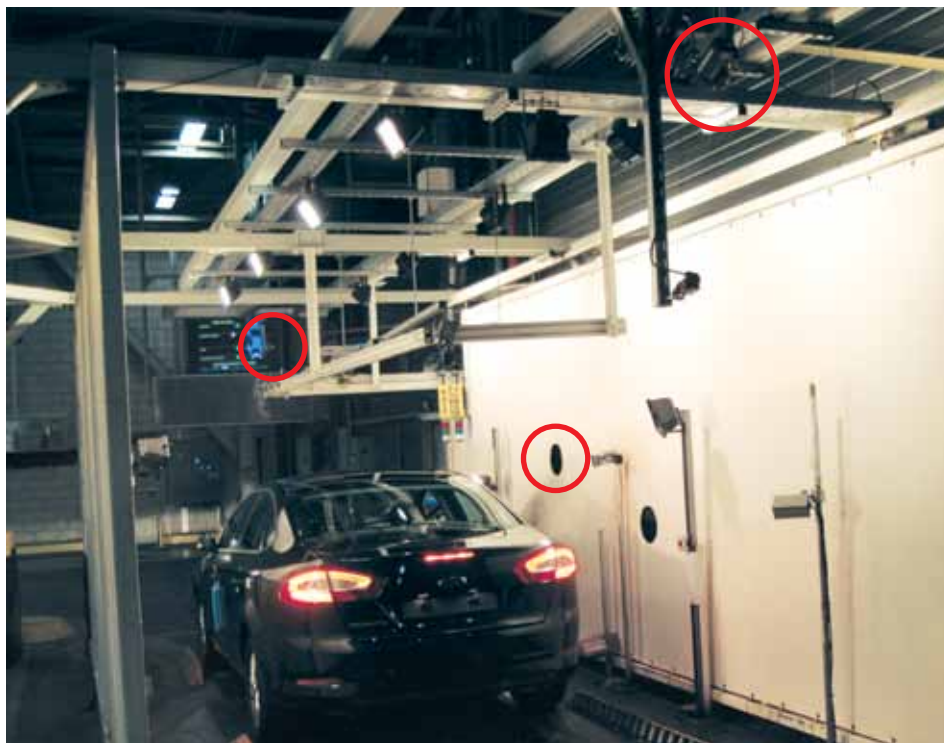
Ford Genk possiede tre termocamere FLIR A320 per testare il sistema di riscaldamento del vetro anteriore, di quello posteriore e del condizionamento dell'aria. Le posizioni delle termocamere sono segnate in rosso.
