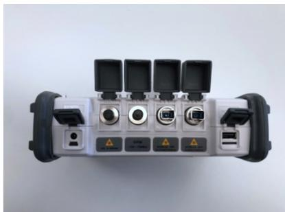
L'OTDR ATO-750 è dotato di interfacce ottiche del tipo SC (sostituibili con FC o ST) sulle porte OTDR, che sono anche utilizzate come porte di uscita quando la funzione "sorgente ottica" è attiva. Le porte Power Meter (OPM) e Visual Fault Locator (VFL) hanno invece una interfaccia universale per connettori SC/FC/ST (ferrula 2,5 mm dia).
