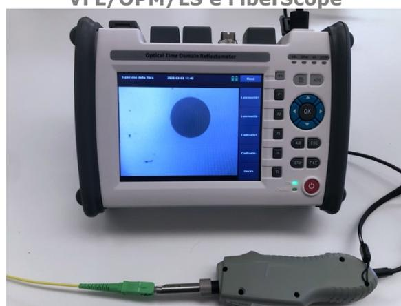
Lo strumento è dotato di serie di funzioni VFL (luce laser rossa visibile), OPM (power meter), LS (sorgente ottica) e FiberScope. Quest'ultima funzione richiede una sonda apposita con interfaccia USB, fornibile a richiesta.
