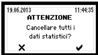
Figura 41 Ripristinare il data logger dell'inverter
