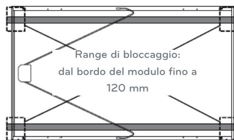
Fissare il modulo con quattro morsetti sul lato corto del telaio. Tale metodo è consentito in presenza di:
