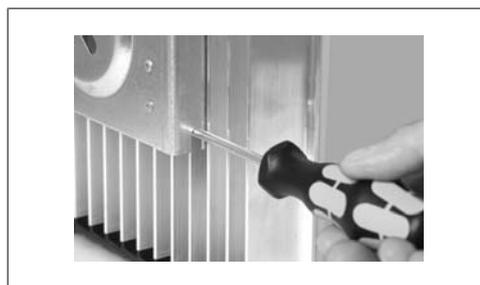
Disegno 8.9: Procedura di rimozione dell'inverter
