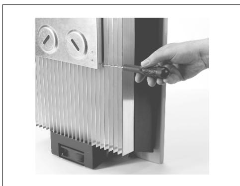
Disegno 8.10: Procedura di rimozione dell'inverter
