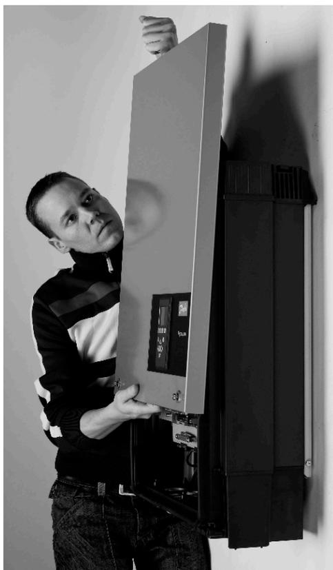
Per chiudere l'inverter, sostenere la parte inferiore del coperchio frontale con una mano e dare un colpo alla parte superiore fino a quando il coperchio cade nella vostra mano. Fare scorrere il coperchio frontale in posizione e stringere le due viti anteriori.
