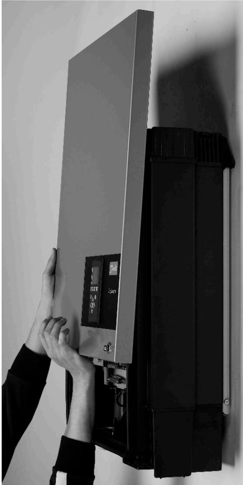
Tirare il coperchio frontale verso l'alto. Quando si avverte una leggera resistenza, dare un lieve colpo alla parte inferiore del coperchio frontale per far scattare il blocco. Si raccomanda di usare la posizione di blocco invece di smontare completamente il coperchio frontale.
