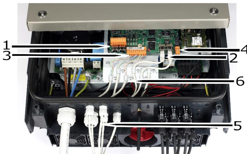
Disegno 6.1: Area connessione ausiliaria: Scheda di comunicazione (1-3), passacavi (5) e pressacavi EMC (6)
