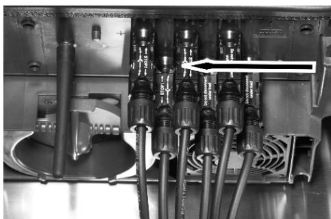
Regolare il sezionatore sotto carico FV sull'inverter in posizione OFF. Collegare i cavi FV usando i connettori MC4. Verificare che la polarità sia corretta. Adesso il sezionatore sotto carico FV può essere commutato su ON quando necessario.
